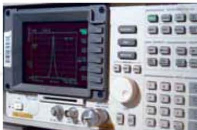
Figura 1.7 Vista de un analizadores de espectro.
