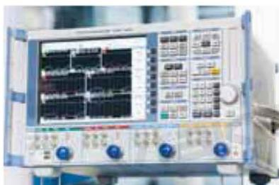
Figura 1.8 Vista frontal de un Analizador de Redes.
